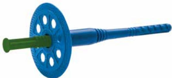
Tacos de 8 mm premontados con un cuerpo y una arandela de 60 mm de  $\varnothing$  fabricados en PP (polipropileno) y un clavo fabricado en PA (poliamida).
